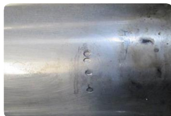
ブランケットシリンダーの欠損修理
