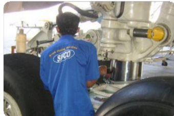
部品を取り外さず現場での修理
